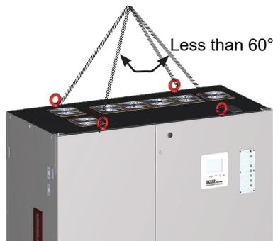
**FIGURE 4.4: CABLES AND EYEBOLTS TO LIFT THE UPS**
