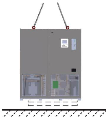
**FIGURE 4.7: UNACCEPTABLE OPERATION**
