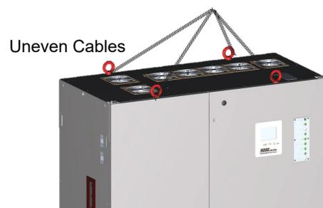
**FIGURE 4.6: UNEVEN CABLES**
