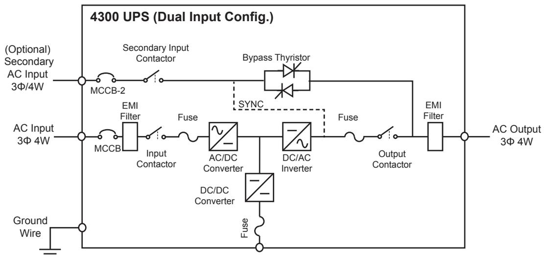
**FIGURE 9.2 - 4300 DUAL INPUT ONE-LINE DIAGRAM**
