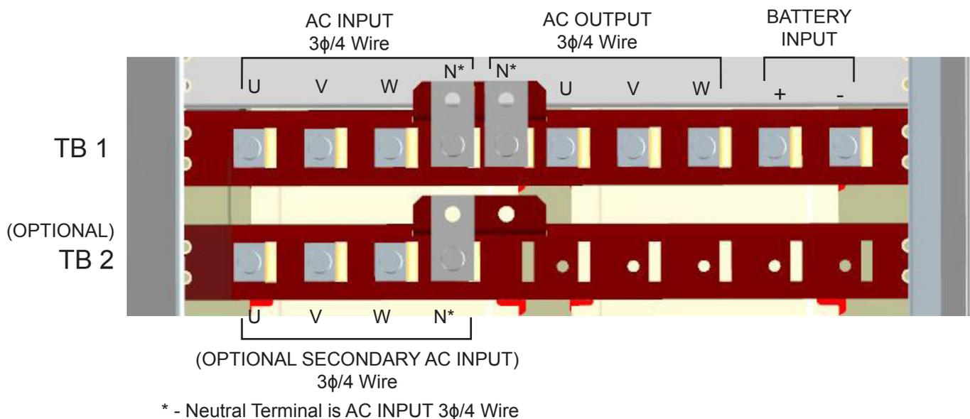
**FIGURE 9.4 - TERMINAL BLOCKS FOR 30/50 KVA UPS**
