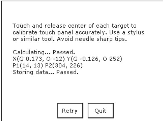
**FIGURE 12-14 TOUCHSCREEN DISPLAY CALIBRATION**
