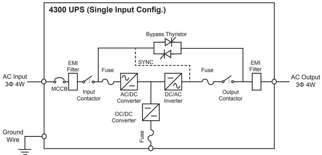
**FIGURE 9.1 - 4300 SINGLE INPUT ONE-LINE DIAGRAM**
